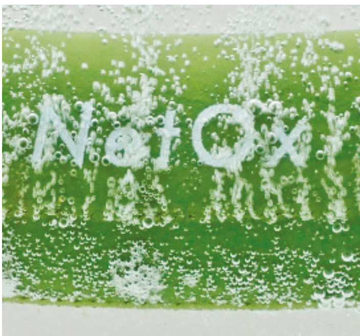
Mikrobobler sikrer god oppløsning av gass
